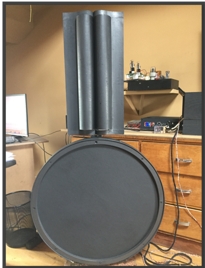
Vertex et Panneau de grave ainsi que leur électronique associée (DAC, Amplificateur)
